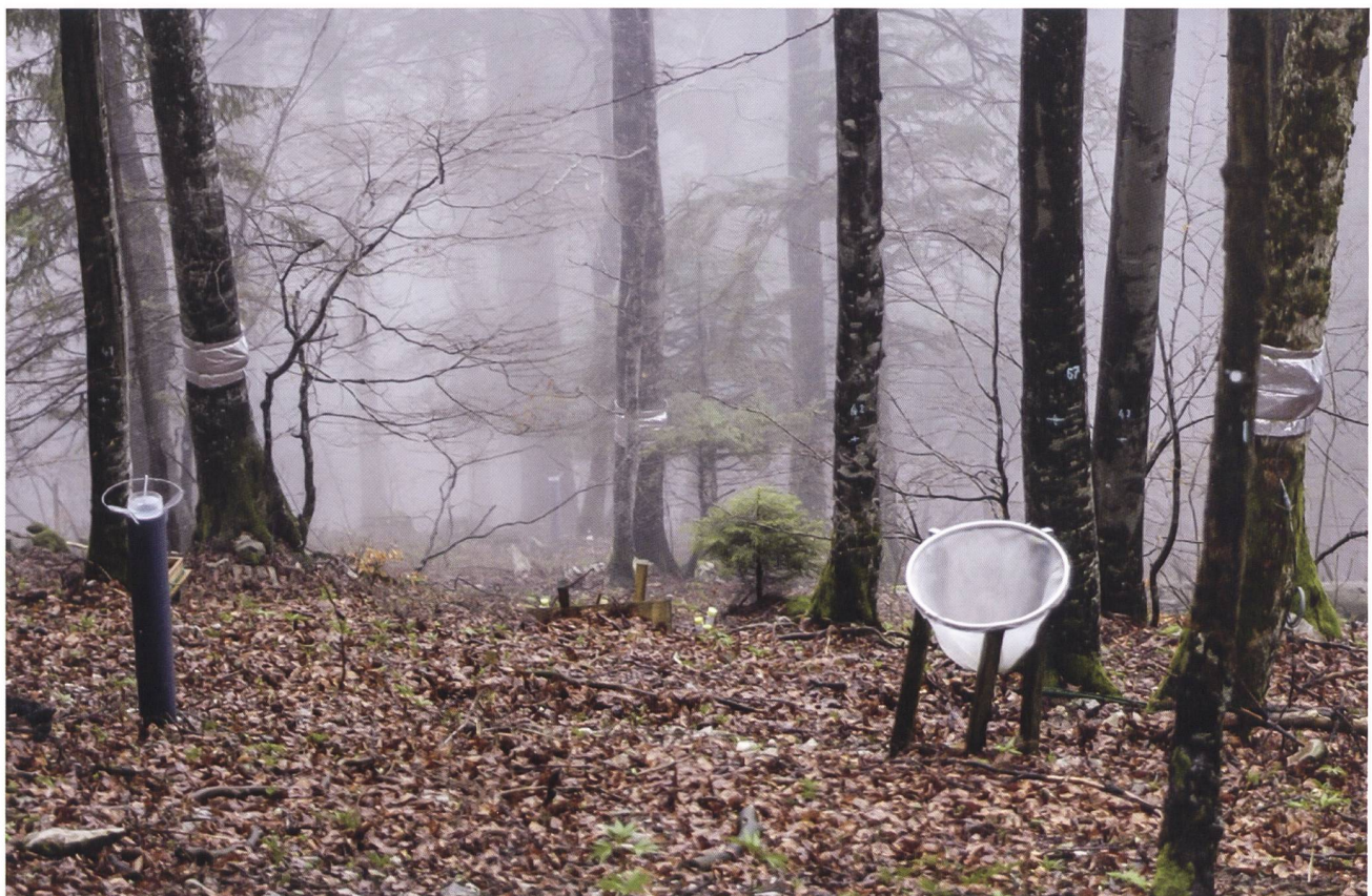
Abbildung 4: Regensammler (links), Tensiometer zur Messung des Matrixpotentials des Bodenwassers (Bildmitte) und Streusammler (rechts) auf der LWF-Fläche am Bettlachstock. Bild: WSL
