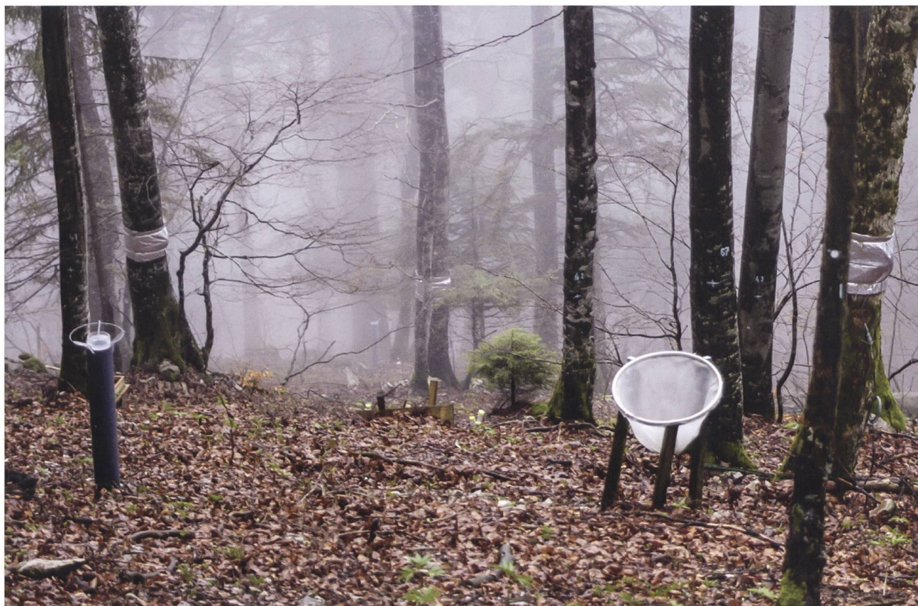
Abbildung 4: Regensammler (links), Tensiometer zur Messung des Matrixpotentials des Bodenwassers (Bildmitte) und Streusammler (rechts) auf der LWF-Fläche am Bettlachstock. Bild: WSL
