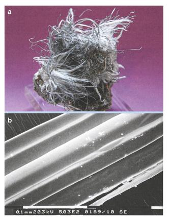
Abbildung 17: a) Steinsalzbüschel, die aus einer ungeordneten porösen Gesteinsschicht gewachsen sind (Mineralienstufenbreite ca. 5 cm) | b) REM-Bild eines einzelnen Haares. Bilder: Fontana (2013)
