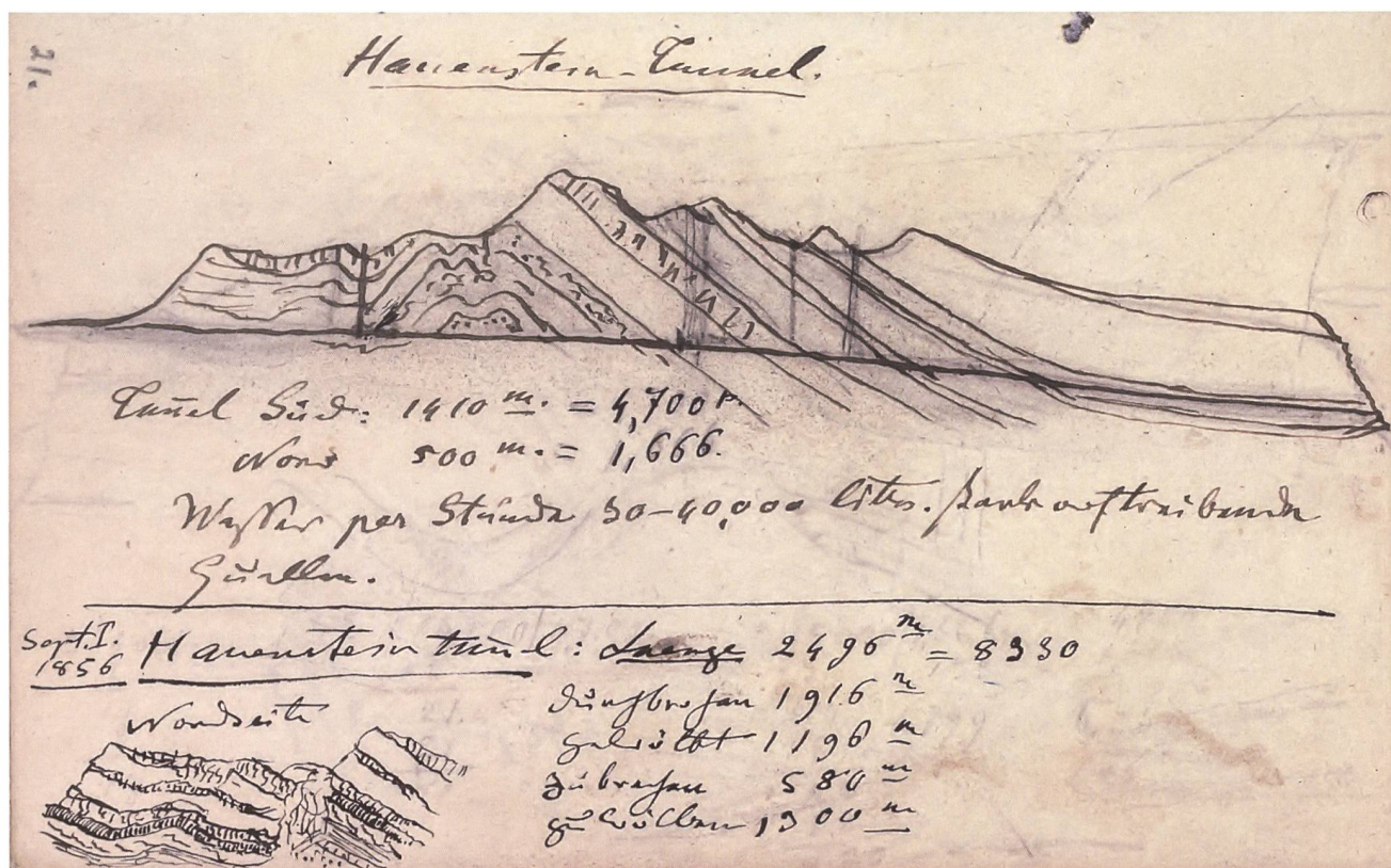
Abbildung 2: Die Arbeit an verschiedenen Tunnelprojekten wird in Gresslys Notizen sichtbar. Hier ist ein Profil des Hauensteintunnels zu sehen. Aus Gresslys Notizbuch II, S. 21
