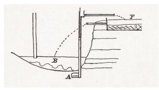
Abbildung 10: Skizze Gresslys von einem grossen Meerwasserbecken. Auf seiner ersten Forschungsreise nach Sète (Südfrankreich) skizzierte Gressly dieses Becken, um in der Heimat Meeresorganismen zu halten. A: Abzugskanal für Schlamm, B: Becken, F: Reinigungsfilter. Aus Rollier, 1913
