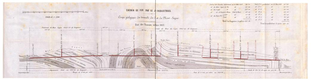
Abbildung 9: Stand der Tunnelarbeiten. Auf Grundlage von Gresslys geologischem Profil der Tunnel Mont Sagne und Les Loges stellt Édouard Desor den Baufortschritt der beiden Tunnel dar. Auffallend ist die moderne Herangehensweise mit mehreren Zwischenangriffen, um die Bauzeit zu verkürzen. Aus Desor, 1856
