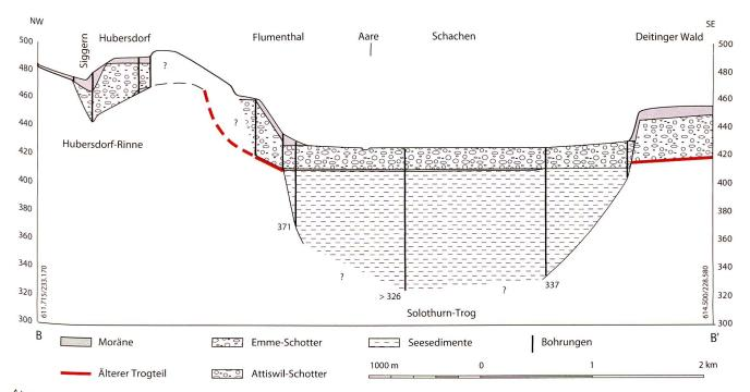
Abb. 3: Querprofil durch die Hubersdorf-Rinne und den Solothurn-Trog, Profilspur siehe Abb. 2
