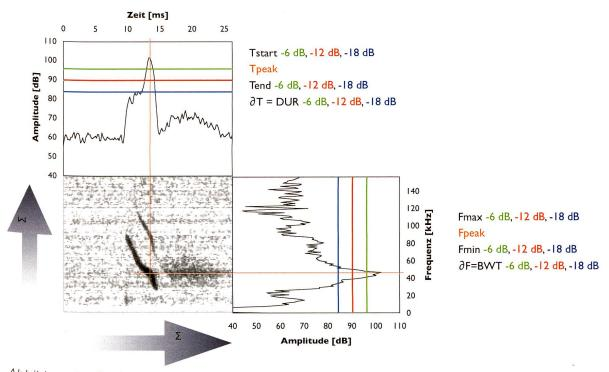
Abbildung 8 – Spektrogrammvermessung Das Spektrogramm wurde für weitere Auswertungen entlang der Frequenzachse (vertikal) zu einer Signalamplitude (oben) und entlang der Zeitachse (horizontal) zu einem Leistungsspektrum (rechts) aufsummiert.
