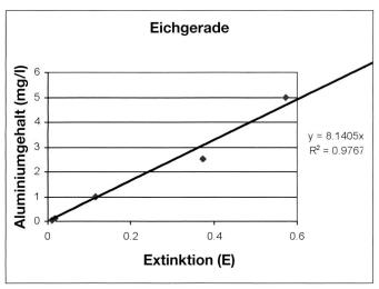
Abbildung 12: Eichgerade der Aluminiumlösungen
