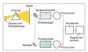
Funktionsweise eines Photometers [7]
