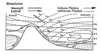
Abb. 2 Das zyklonale Hauptstadium des Föhns mit dem baroklinen Temperatur- und Druckfeld (Solenoidfeld) und den Strömungsrichtungen.
