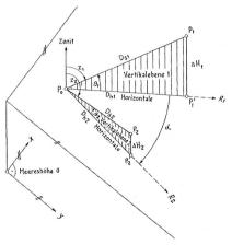
Abbildung 1: Horizontal- und Vertikalwinkel
