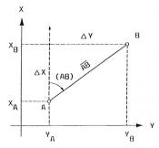
Abbildung 2: Azimut
