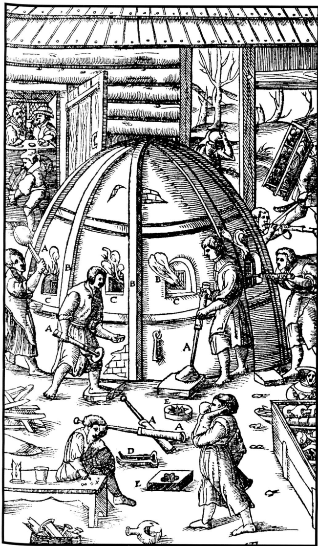
Glasofen zur Herstellung fertiger Glaswaren Die Pfeifen A. Die kleinen Fenster B. Die Marmorplatten C. Die Zange D. Formen für die Gestaltung der Glaswa- ren E. (aus: Agricola, 1556)
