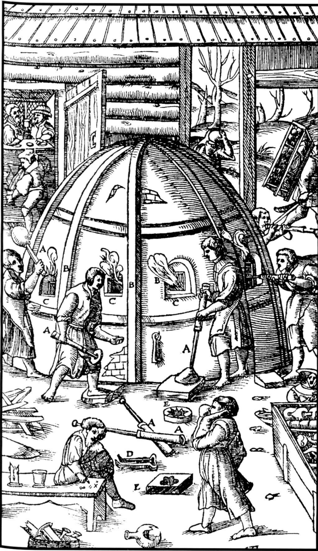
Glasöfen zur Herstellung fertiger Glaswaren Die Pfeifen A. Die kleinen Fenster B. Die Marmorplatten C. Die Zange D. Formen für die Gestaltung der Glaswaren E. (aus: Agricola, 1556)
