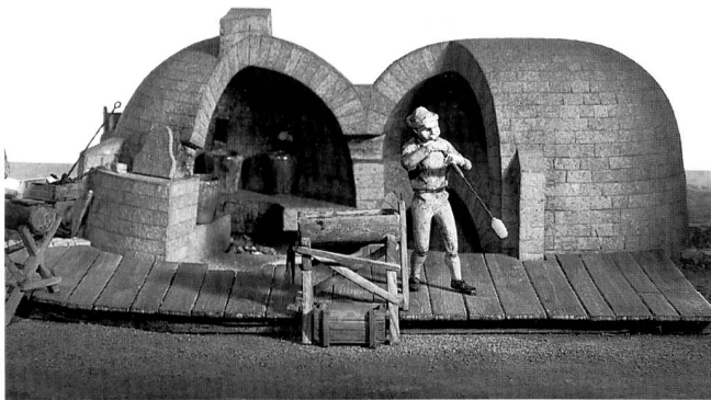
Glasschmelzofen nach Johann Kunckel, 17. Jahrhundert: gut sichtbar sind die Schmelzgefäße im Inneren des Ofens (Modelldarstellung des Deutschen Museums). Foto: Deutsches Museum München
