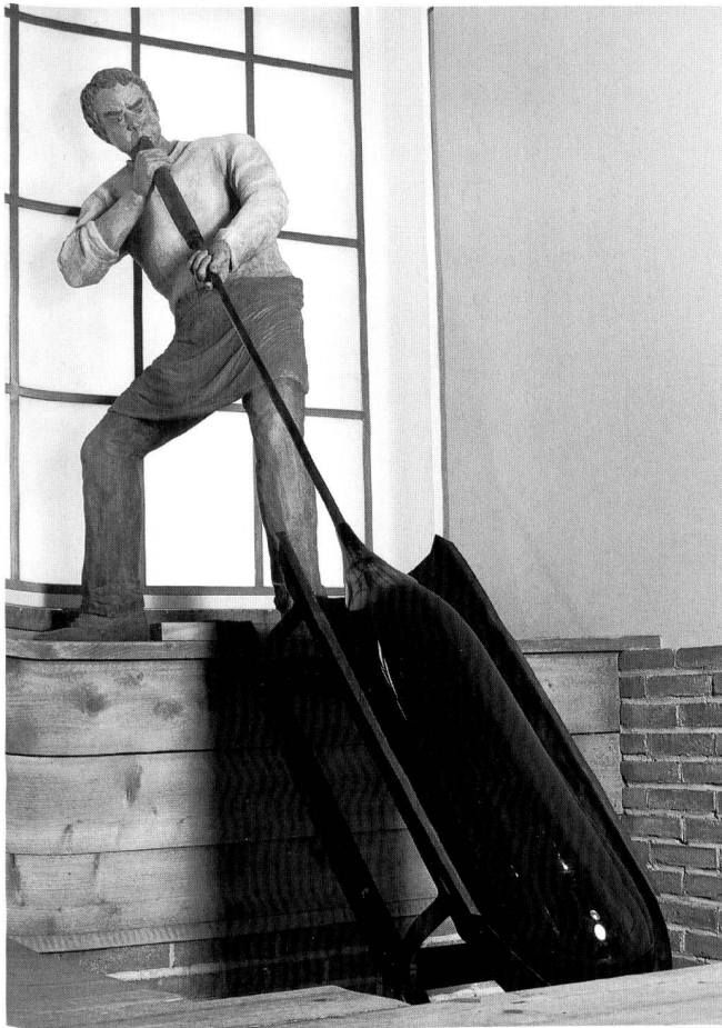
Glasbläser mit einem fast fertigen Glaszylinder auf dem Glashobel, Rekonstruktion im Deutschen Museum München. Foto: Deutsches Museum München
