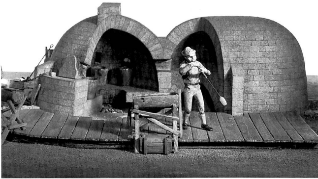
Glasschmelzofen nach Johann Kunckel, 17. Jahrhundert: gut sichtbar sind die Schmelzgefässe im Inneren des Ofens (Modelldarstellung des Deutschen Museums). Foto: Deutsches Museum München
