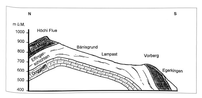
Abb. 3: Geologisches Querprofil durch die Höchi Flue 1:10 000 (nach geologisch-hydrologischem Bericht, Wasserversorgung Egerkingen)
