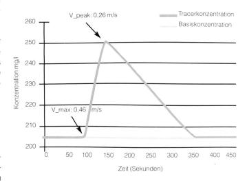
Abbildung 1: Konzentrationskurve des Tracerversuchs
