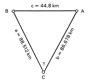
Nach dem Kosinussatz erhalten wir für den Horizontalwinkel  $\gamma \triangleq \alpha = 29,6^{\circ}$
