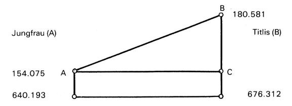
Die Strecke  $\overline{AC}$  wird berechnet: 676.312 - 640.193 = 36,119 km. Die Strecke  $\overline{BC}$  wird berechnet: 180.581 - 154.075 = 26,506 km.
