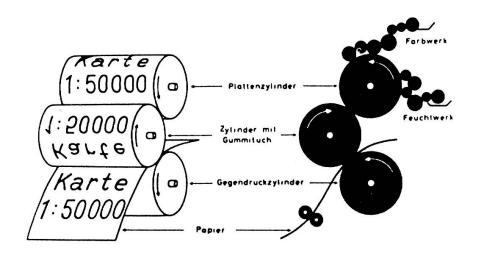
Abb. 15 - Offsetdruck (Schema)
