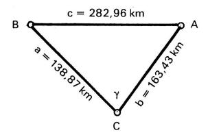
Nach dem Kosinussatz erhalten wir für den Horizontalwinkel  $\gamma \triangleq \alpha = 138,64^\circ$
