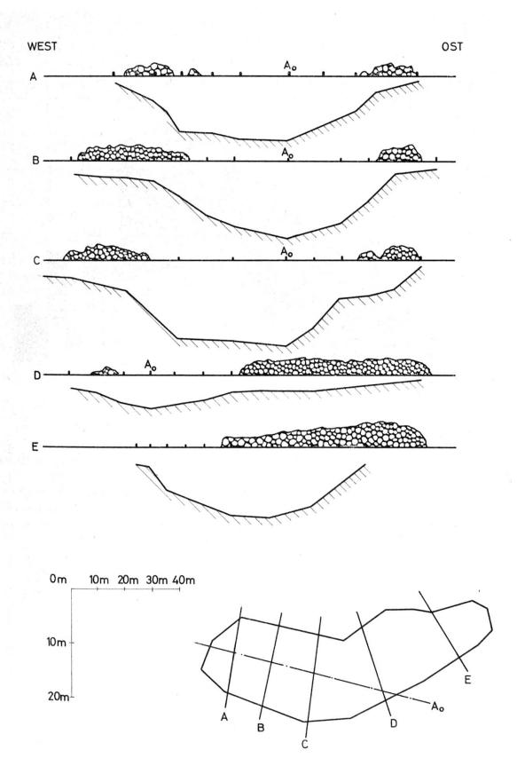
Fig. 3 (S. 13): Schnittdarstellung von fünf der insgesamt sieben Transekt-Profilbohrungen zur Abklärung des Untergrundes und der Muldenform.
