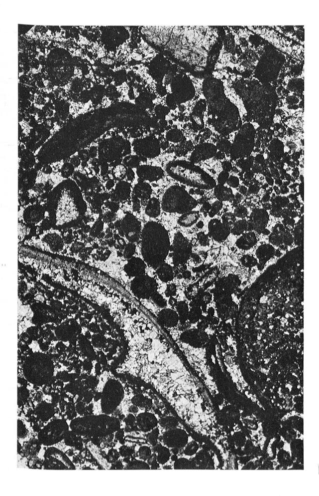
Peel. Vergrößerung: 14 ×. Verenaschichten, «Obersequanien». Alter Steinbruch der Zementwerke Vigier S.A., Péry/Reuchenette 585.810/226.140. Kalkarenit mit sehr gut gerundeten Komponenten in sparitischer Grundmasse. Fast alle Komponenten zeigen eine ganz schwache Ummantelung mit kryptokristallinem, kalzitischem Material, eigentliche Ooide sind selten. Zoogener Detritus ist nur in verschwindend kleinen Mengen vorhanden und setzt sich vorwiegend aus Echinodermenfragmenten zusammen. Gesteinstyp: Ii.
