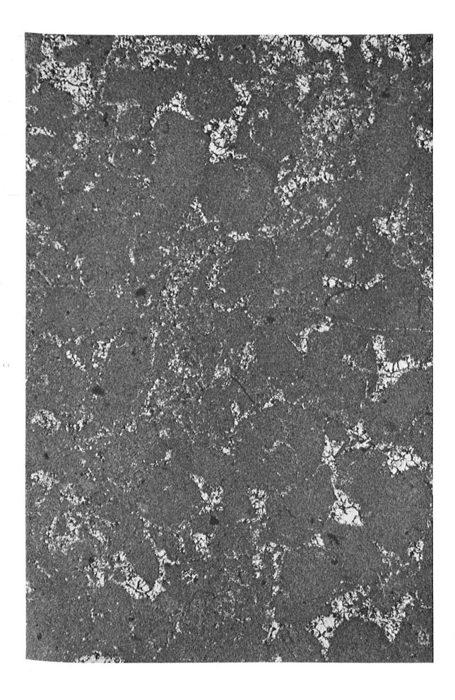
Peel. Vergrößerung: 17,5 ×. Reuchenetteformation, «Kimmeridgien». Typlokalität der Reuchenetteformation, 585.840/226.240 (vgl. Fig. 5, Banknummer 73). Kryptokristalliner (mikritischer) Kalk. Die vorhandenen Fissuren wurden, vermutlich syndiagenetisch, durch rekristallisierten, sparitischen Kalzit ausgefüllt. Gesteinstyp: vermutlich IIImX.
