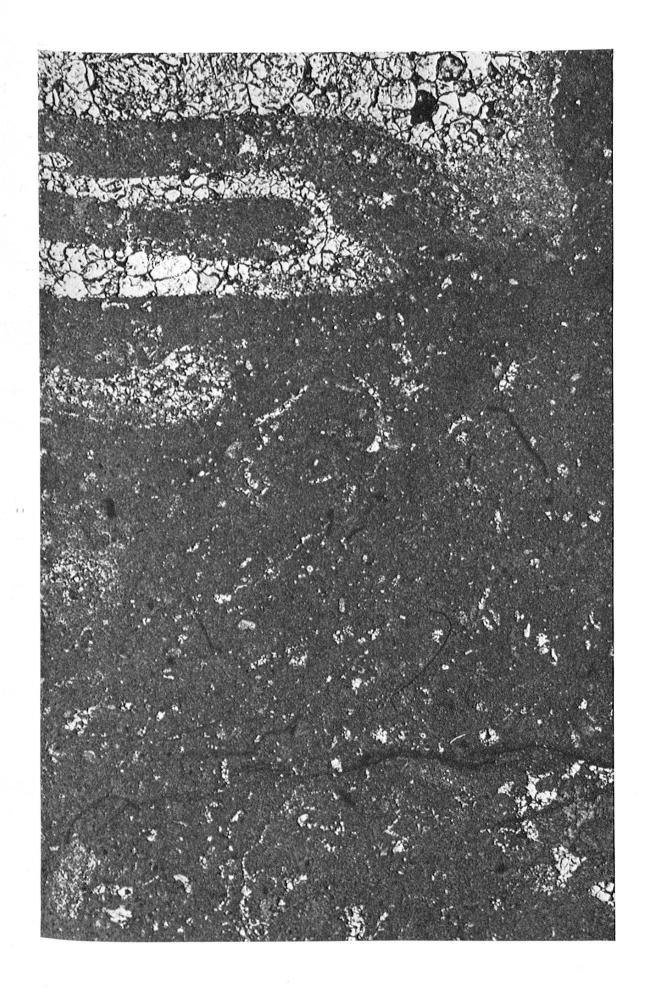
Peel. Vergrößerung: 20 ×. Reue henetteformation, «Kimmeridgien». Typlokalität der Reuchenetteformation, 585.840/226.240 (vgl. Fig. 5, Banknummer 81). Dichter, kryptokristalliner Kalk mit unbestimmbarem und rekristallisiertem zoogenem Detritus. Verbreitetster Gesteinstyp innerhalb der Reuchenetteformation. Gesteinstyp: IIImX bis IIb.
