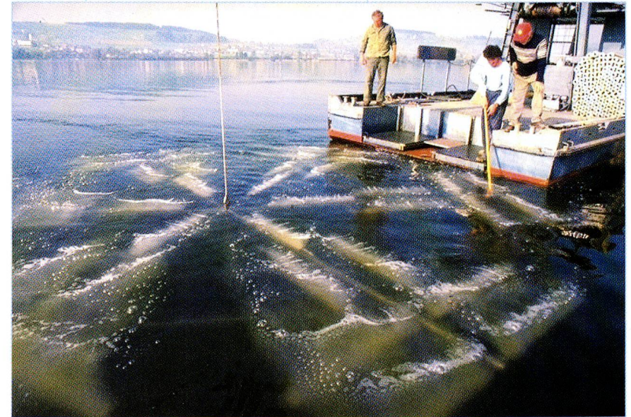
Abb. 4: Belüftungsanlage im Sempachersee. Aus den Diffusoren perlte von 1985 bis 1997 Reinsauerstoff. (Foto: Pius Stadelmann)
