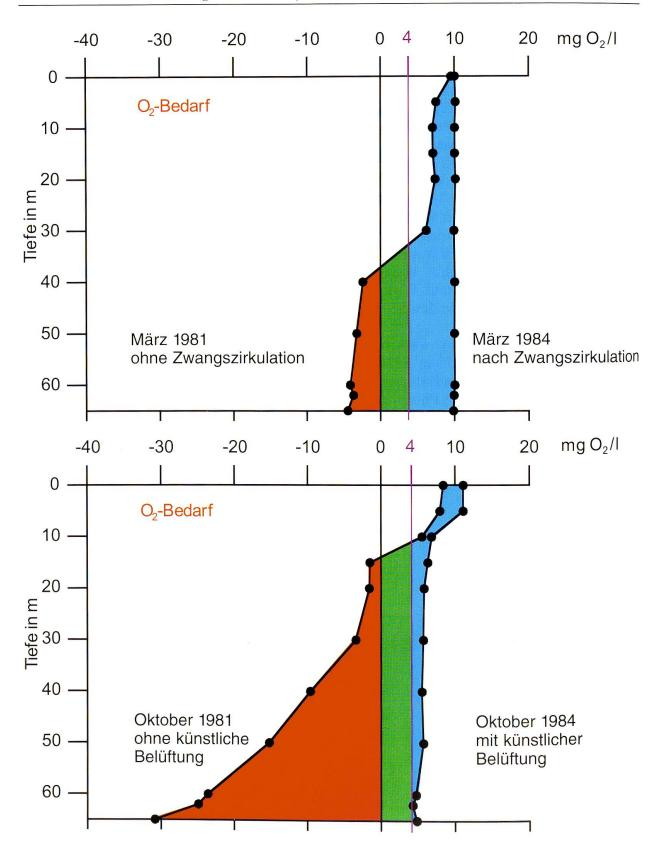
Abb. 11: Sauerstoffkonzentrationen im Baldeggersee nach der Oxidation der reduzierten Substanzen 1981 (ohne künstliche Belüftung) und 1984 (mit künstlicher Berlüftung) in mg  $O_2$ /l. Die negativen Werte bedeuten den  $O_2$ -Bedarf für die Oxidation von  $NO_2$ -,  $NH_4$ +,  $H_2S$ ,  $CH_4$ ,  $Fe^2$ + und  $Mn^2$ +.
