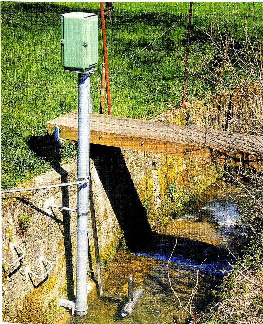
Abb. 24: Abflussmengenmessstation des Mülibaches bei Retschwil. Limnigraf und Probenahmengerät für Chemie, in Betrieb seit 1985.
