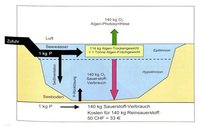
Abb. 10: Wirkung der Zufuhr von 1 kg Phosphor auf die Algenproduktion und den Sauerstoffverbrauch im Hypolimnion eines Sees.
