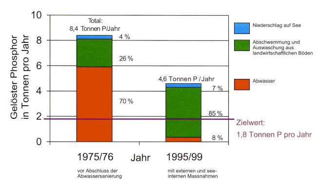
Abb. 26: Zufuhren an gelöstem Phosphor in den Baldeggersee für die Jahre 1975/76 und 1995/1999 in Tonnen und Aufschlüsselung auf verschiedene Verursacher.
