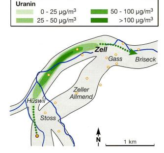
Abb. 5: Die räumliche Verteilung der Sulforhodamin- und der Uranin-Konzentrationen Anfang Mai 1997 im Grundwasser. Sulforhodamin wurde als Markierstoff in «P 3» (ins Rottal) eingeimpft und blieb im Rottal respektive Lutherntal. Uranin wurde als Markierstoff in «Ze 4» (in die Urluthernrinne) eingegeben und floss ins Rottal respektive Lutherntal.
