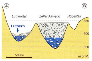
Abb. 3: Querprofil durch das Lutherntal und die Urluthernrinne zwischen Zell und Zeller Allmend (fünffach überhöht, Profilspur in Abb. 2).
