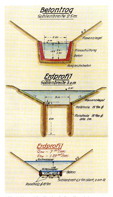
Abb. 4: Normal-Profile der 2. Ron-Korrektion 1942.
