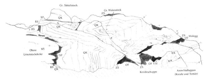
Abb. 1: Ansicht der Oberen Urirotstock-Decke (Sättelistöcke – Walenstöcke). Blick von Schoneggli gegen Westen. Weiss: kompetente Kalksteine; dunkel: inkompetente Mergel und Tonschiefer; Falten-Achsenspuren gestrichelt. RS: Reischiben-Serie; SF: Schilt-Formation; QK: Quintner-Kalk/Quinten-Formation; ZS: Zementstein-Formation; OF: Öhrli-Formation; VM: Vitznau-Mergel; BK: Betlis-Kalk; KK: Kieselkalk.
