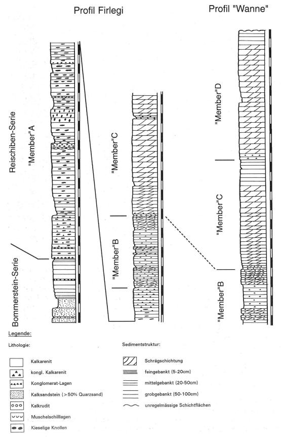
Abb. 2: Stratigraphische Profile des Dogger (spätes Aalenian – Bajocian). Balkenlänge: 2 m. Koord.: Profil Firlegi: 677.860/190.350 nach 677.660/190.110; Profil «Wanne»: 676.550/190.070 nach 676.280/190.060.
