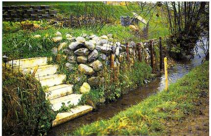
Abb. 4: Stägbach stark beeinträchtigt durch künstliche Uferverbauungen, steile Uferböschung und Aufschüttungen.
