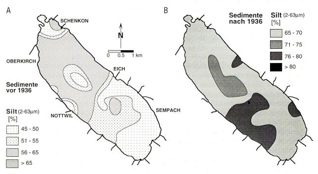
Abb. 5: Die Siltanteile (Korngrössen 2 bis 63 µm) der nach 1936 abgelagerten Sedimente (B) sind entsprechend der Zunahme ihres Siltgehaltes im gesamten See deutlich grösser als in den vor 1936 abgelagerten Sedimenten (A). Gleichzeitig zeigen beide Darstellungen, dass das Sedimentmaterial der Zuflüsse keinen Einfluss auf die Korngrössenverteilung der Sedimente im Sempachersee hat.
