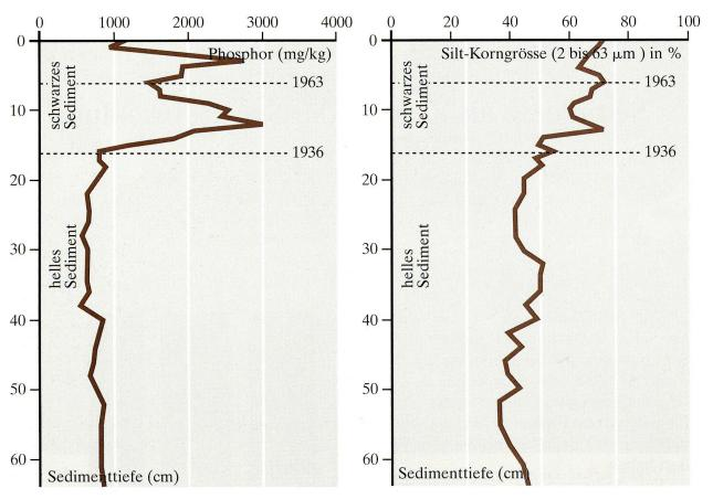
Abb. 2: Die markante Erhöhung der Phosphor-Konzentration in 16 cm Sedimenttiefe eines Sedimentkerns aus dem Sempachersee (Abb. 1) fällt mit dem Beginn der Schwarzfärbung im Jahre 1936 zusammen. Die Konzentrations-Abnahmen um 1963 beziehungsweise 1985 sind bedingt durch Rücklösungsprozesse von Phosphor in die überlagernde Wassersäule und nicht durch Verbesserung der hoch-eutrophen Seebedingungen.
