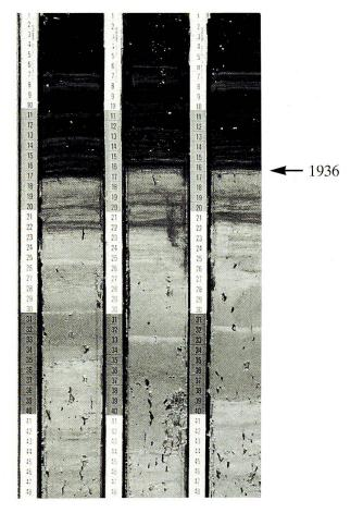
Abb. 1: Sedimentkerne, entnommen im September 1984 aus 87 m Wassertiefe in der Seemitte vor Eich. Gut erkennbar ist der plötzliche Farbwechsel in 16 cm Kerntiefe, welcher den Übergang von einem nährstoffarmen (oligotrophen) zu einem nährstoffreichen (hocheutrophen) Seeregime verdeutlicht (Massstab in cm).
