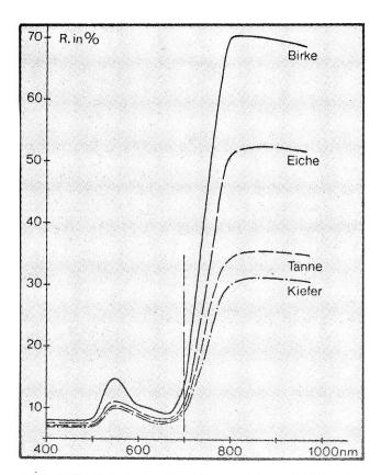
Abb.1: Spektrale (wellenlängenabhängige) Rückstrahlung verschiedener Baumarten (BACKSTRÖM und WELANDER, 1953).
