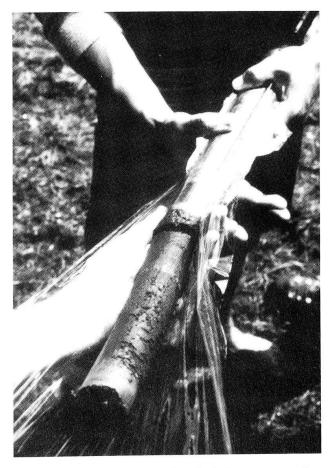
Abb. 7: Das Ausstossen des Bohrkernes aus der Dachnowsky-Sonde.
