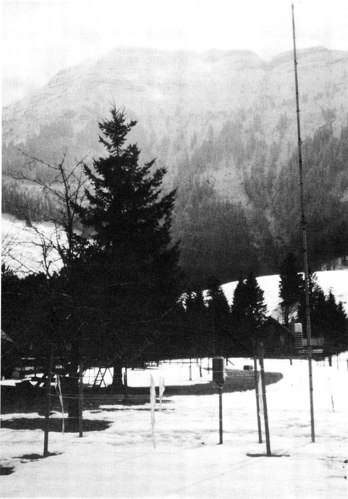
Fig. 3: Die mittlere Messstation auf Seeboden mit der verwendeten Instrumentierung. Rechts sieht man den Windmast mit Feuchtigkeitsmesser, in der Bildmitte den Regenmesser und links davon am Boden das Distrometer.
