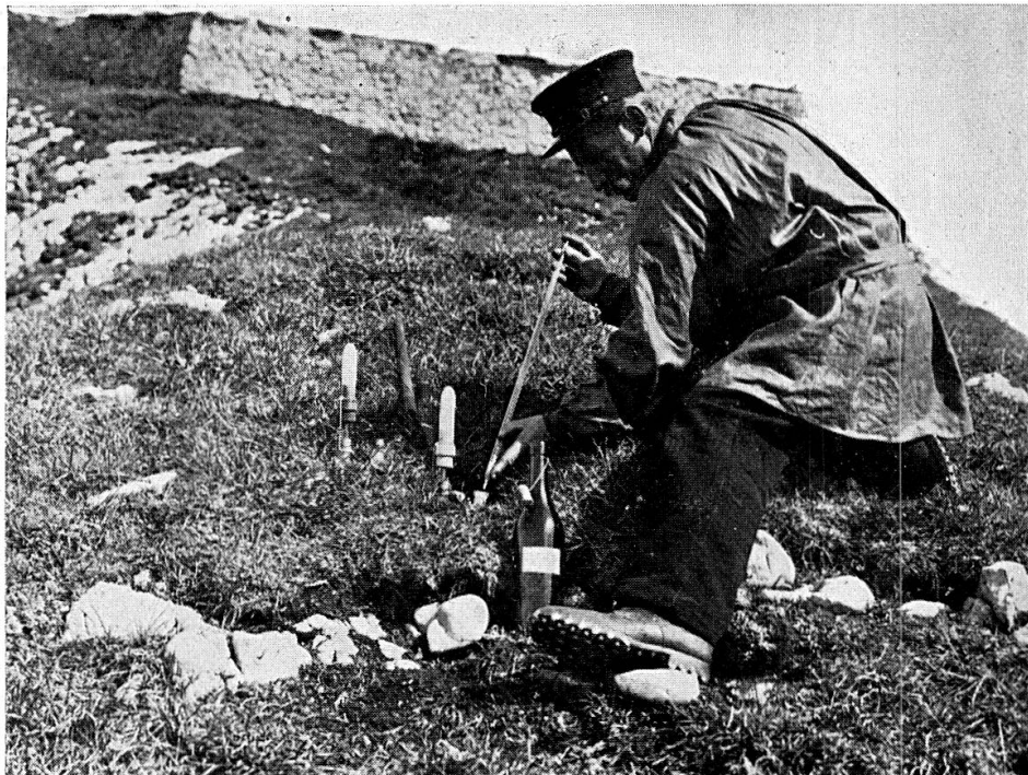
Abb. 10. Die Atmometer auf dem Esel werden nachgefüllt durch den Stationswärter der Pilatusbahn.
