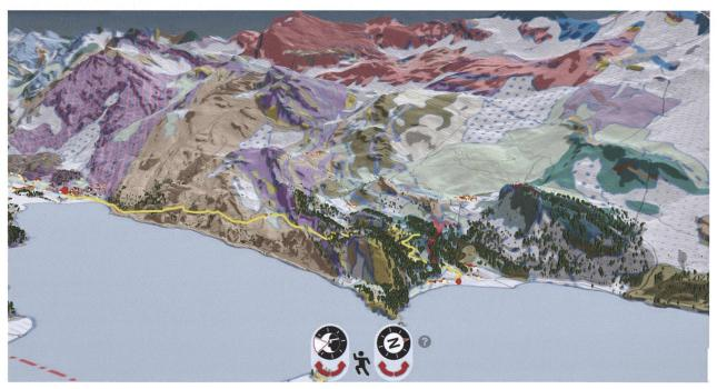
Abb. 5: 3D-Rekonstruktion der geologischen Verhältnisse beim Sasc da Corn am Nordufer vom Silsersee. Gut sichtbar sind die steilstehenden triadischen Dolomite in Gelb in komplizierter tektonischer Beziehung zu Liaskalken in Lila. In der Fortsetzung dieser Karbonate im See liegt der hydrographische Kontakt zum Karstsystem. Die gelbe Linie markiert den Wanderweg von Plan di Mort nach Plaun da Lej (Kompilation: St. Altner mit Daten von swisstopo).
