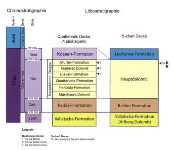
Abb. 3: Lithostratigrafische Übersicht und Vergleich der S-charl- und Quattervals-Einheit (umgezeichnet nach Dösegger et Al. 1982).
