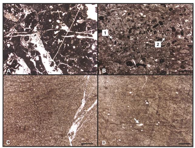
Abb. 5: Dünschliffbilder der Gesteinstypen. A: SC 19-2, B: SC 19-4, 1 Dasycladacee 2 benthische Foraminifere, C: SC-19-5, D SC 19-7 Pfeil key stone vug (Balkenlänge 5 mm, Erläuterungen siehe Text). Die Nummerierungen korrespondieren mit denen im Profil von Abb. 4.
