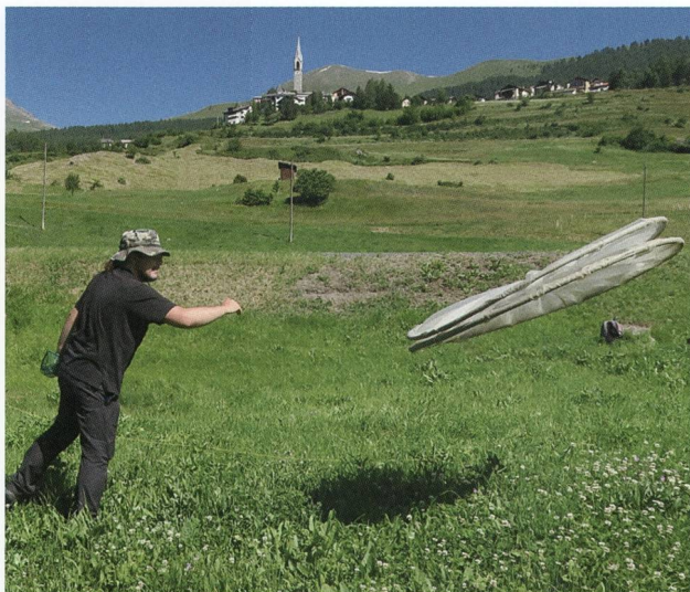
Abb. 1: Funktionsweise des Biozönometers: Wurf in geschlossenem Zustand (Foto: M. Schneider).
