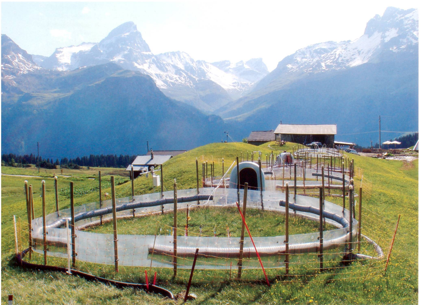
Abb. 1: Freiluftbegasungsanlage auf der Alp Flix.
