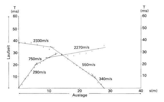
Abbildung 4: Das Refraktionsseismische Profil Nr. 12 ist ein Beispiel aus dem gewählten Talquerschnitt. Der aus der entgegengesetzten Schlagrichtung gewonnene Mittelwert von  $v_3$  mit 2300 m/s liegt im Bereich von Permafrostmaterial um 0 Grad. Die gerechnete Tiefe der Permafrostoberfläche (Permafrostspiegel) beträgt  $D_2 = 5$  m.
