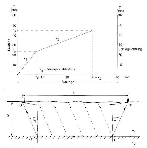
Abbildung 3: Berechnung der Schichtdicke im Refraktionsverfahren.
