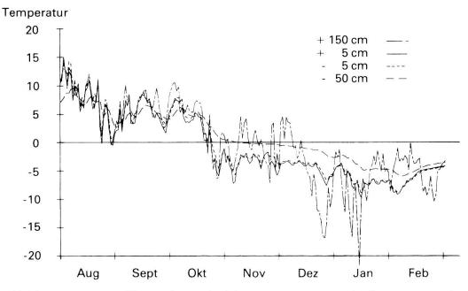
Abbildung 5: Diese Grafik zeigt den Verlauf der Temperatur in verschiedenen Lagen während den Monaten August 1986 bis Februar 1987. Deutlich ist die Dämpfung mit zunehmender Tiefe erkennbar.
