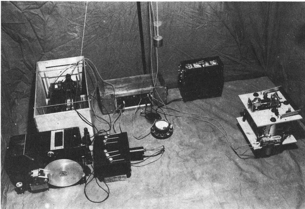
Abb. 5 Die seismische Apparatur von A. Kreis (im Apparate-Zelt). Rechts der Gletscherseismograph, links das Registriergerät. Hinten die Stimmgabel für die Zeitmarken, sie steuert eine Heliumröhre, die 50mal in der Sekunde aufblitzt.
