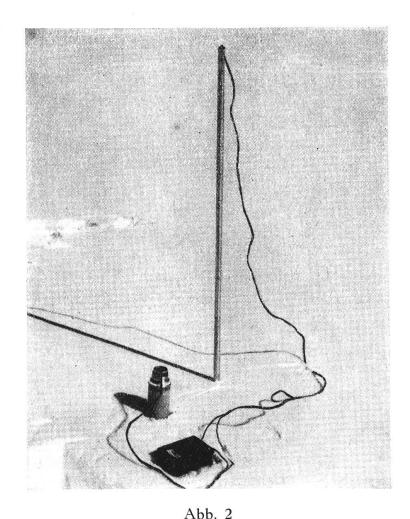
Thermosonde mit Thermosflasche und Weston-Galvanometer im Schneefeld
