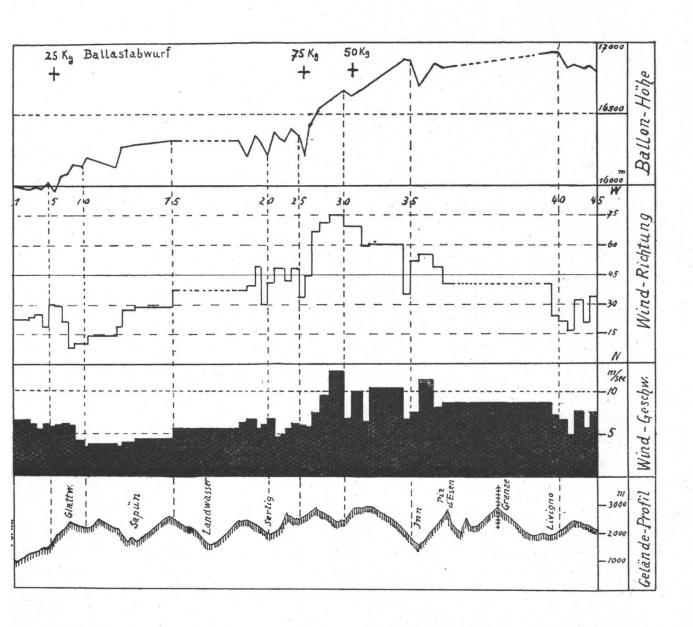
Abb. 2. Ballonhöhe, Windrichtung und Windgeschwindigkeit als Funktion des Weges dargestellt.
