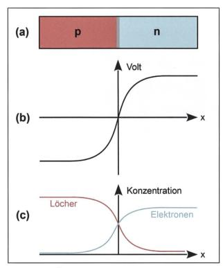
**Abb. 6**: (a) Übergang von einem p-dotierten Halbleiter (links) zu einem n-dotierten (rechts).
