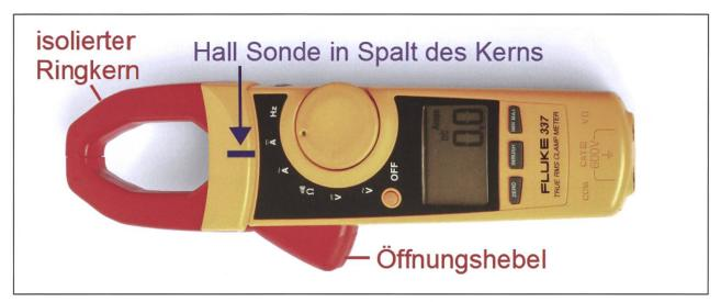
Abb. 5: Stromzange zur berührungslosen Messung der Stromstärke in einem Draht (Bild: Harke public domain, Text Fritz Gassmann).
