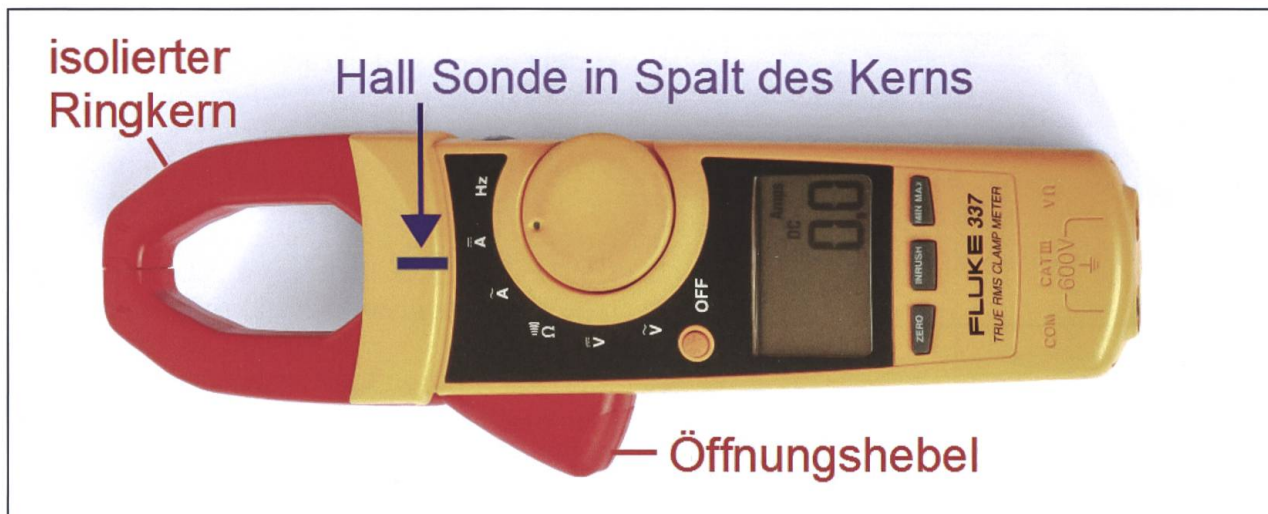
Abb. 5: Stromzange zur berührungslosen Messung der Stromstärke in einem Draht (Bild: Harke public domain, Text Fritz Gassmann).
