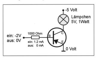
**Abb. 15**: Transistor als Schalter ersetzt Relais. Das 1-Watt-Lämpchen wird mit einem Strom von etwa 1,2 mA bei 2 Volt eingeschaltet. Die für das Einschalten aufzuwendende Leistung beträgt nur 2,4 mW, rund 400-mal weniger als das Lämpchen (Bild: Fritz Gassmann).
