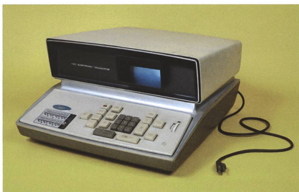
Abb. 24: Zweite Serie des weltweit ersten voll transistorisierten Tischrechners Friden Inc. San Leandro (California) Modell EC-132, das ab 1965 verkauft wurde. Mit einem Gewicht von 21 kg kostete er rund 20'000 $ (auf heutigen $-Wert umgerechnet). Er konnte die vier Grundoperationen mit 13-stelligen Festkomma-Zahlen durchführen und zusätzlich Quadratwurzeln ziehen und eine Zahl zur Wiederverwendung speichern. Er enthielt nur 324 Transistoren für die CPU und einige weitere für die Darstellung der 7-Segment-Zahlen, das Delay Memory und das Speisegerät. Um teure Transistoren zu sparen, wurde sein Arbeitsspeicher durch einen Metalldraht als Delay Line realisiert, in dem die gespeicherten Bits als mechanische Torsionswellen mit Schallgeschwindigkeit wanderten und für eine Speicherung durch die Elektronik laufend vom Drahtende gelesen und am Drahtanfang wieder eingegeben wurden (Bild: Children's Museum of Indianapolis, CC BY-SA 3.0).
