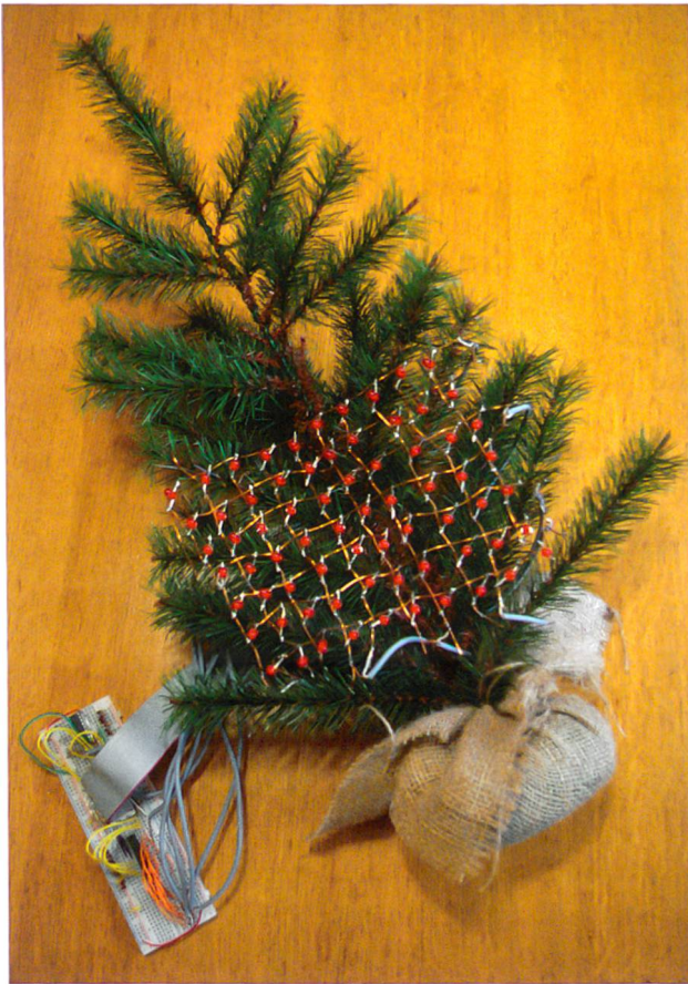
Abb. 4: Eine LED-Matrix, die am Raspberry Pi angeschlossen und einen Lauftext darstellen kann.
