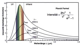
Abb. 3: Plancksches Strahlungsgesetz. In der Formel für die Intensität der Strahlung eines schwarzen Körpers begrenzt der zweite Term die Emission stark, sobald h·v grösser als kT ist, also bei hohen Frequenzen v. Mit zunehmender absoluter Temperatur T (in Grad Kelvin) werden höhere Frequenzen und zufolge des ersten Terms mit höherer Energie ausgestrahlt (Grafik E. F. Schubert, Light Emitting Diodes slide show).
