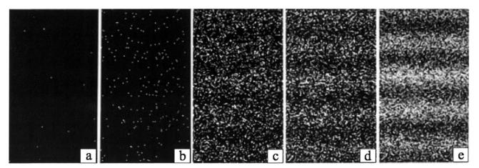
**Abb. 11:** Doppelspaltexperiment durchgeführt mit 11 (a), 200 (b), 6'000 (c), 40'000 (d) und 140'000 (e) Photonen (Bild zur Verfügung gestellt durch Tonomura, user:Belsazar, 2012).
