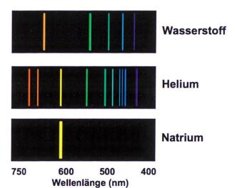
Abb. 7: Sichtbare Emissionslinien von Wasserstoff, Helium und Natrium. Die Linien sind wie Fingerabdrücke der Atome, mit denen z. B. die Zusammensetzung von Sternatmosphären bestimmt werden kann. Da Atome bei denselben Frequenzen auch absorbieren, treten die Linien vor dem Hintergrund der kontinuierlichen Schwarzkörperstrahlung von Sternen als dunkle sog. Fraunhofer-Linien auf (Bild E. und M. Fornoff, Landau (D) 2007).
