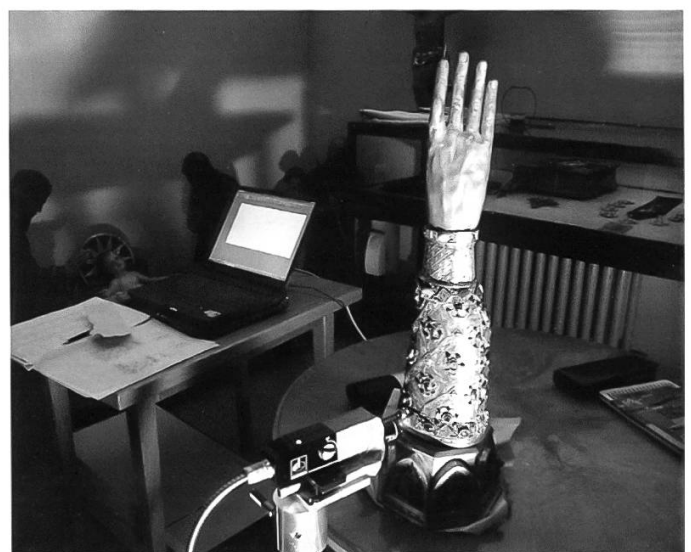
Abb. 1: Mobiles Raman Remote System von Renishaw mit Armreliquiar der heiligen Verena (Zurzach).
