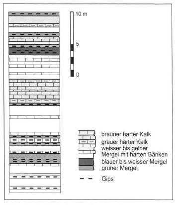
**Abb. 7:** Geologisches Profil der Tüllinger Süsswasserkalke (Baugrube des Kraftwerks Birsfelden): In verschiedenen Lagen wurden bis 20 cm grosse Gipskristalle gefunden (Quelle: Baugrundarchiv Basel-Stadt und Aegerter & Bosshardt AG, Basel).
