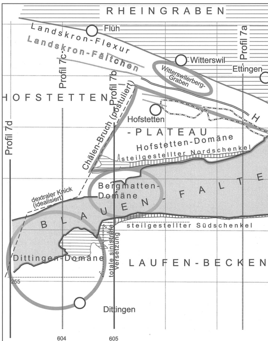
Abb. 4: Vereinfachte Darstellung der Elemente des TWD-Trends im Blauen-Landskronbereich. H = Hofstetten-Störung. Die Figur dient vor allem dem Namensverzeichnis der tektonischen Elemente sowie der Lokalisierung der Profile der Abb. 7. Zusätzlich sind schematisch angegeben der dextrale Knick des TWD-Trends und der diffuse sinistrale Transfer im Blauen-Südschenkel (eng schraffiert: Malm-Schenkel der östlichen Blauenfalte). Im übrigen gilt auch für diese Figur wie für Abb. 3 die Empfehlung, die entsprechenden publizierten Kartenblätter zu konsultieren und eventuell im Computer zu überlagern.
