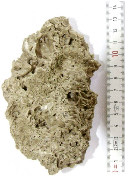
Abb. 3: Handstück aus Quellkegel südlich des Schlosses (Standort 2). Mürber, hochporöser Kalktuff, beige, mit drusigen Calcitauafällungen in Hohlräumen, Abdrücke von Blättern und Ästen.
