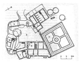
**Abb. 2:** Grundriss der heutigen Schlossanlage. 1. Ehemaliges Gärtnerhaus mit Ökonomie. 2. Eingangstor. 3. Burghof. 4. Rundturm. 5. Ringmauer mit Terrasse. 6. Plantabau 7. Zwischentrakt. 8. Torbau. 9. Zwinger. 10. Wohnturm. 11. geometrischer Ziergarten.
