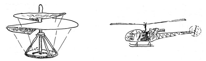
**Abb. 6:** Vom Plan zur effektvollen Struktur: Der von Leonardo da Vinci im 15. Jahrhundert entworfene Flugapparat soll seinen Auftrieb durch eine grossflächige wendelgestaltige Luftschraube erhalten. Der moderne Helikopter wird dank der schmal gestalteten und schräggestellten Rotorblätter flugfähig.
