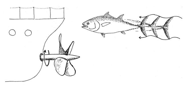
**Abb. 1:** Technische und biologische Propeller. Am Heck des Schiffs erzeugt die (Rad-) Schraube dank ihrer schräggestellten (vier) Flügel einen Wasserstrom nach hinten; dies bewirkt einen Vortrieb des Schiffs. Beim Thunfisch (*Thunnus thynnus*) wird die sichelförmige Schwanzflosse hin- und herbewegt (der Weg der Propellerblattspitzen ist in der Bewegungsrichtung markiert). Die Flosse wird jeweils beim Richtungswechsel in die neue Schräglage gekippt.
