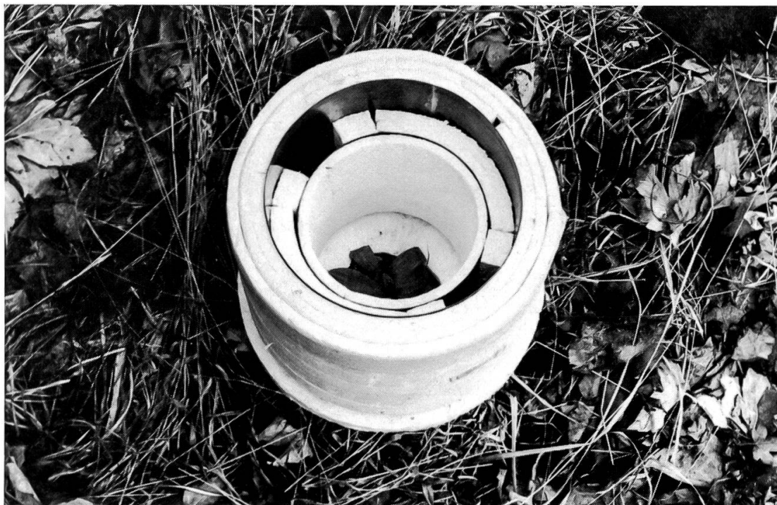
Abb. 20: Das Versuchsgefäss auf der Styropor-Bodenplatte. Links oben und rechts unten befinden sich die beiden Öffnungen zur Aufnahme des Trockeneises.
