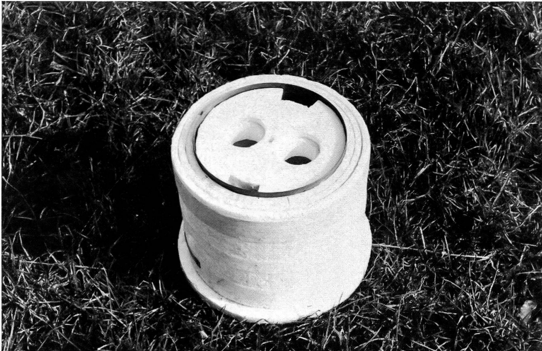
Abb. 21: Gefäss mit dem inneren Deckel. Die beiden kreisrunden Öffnungen dienen zur Regulierung der Innentemperatur während des Versuches. Nach Versuchsende wird durch mehr oder weniger starkes Öffnen eine langsame Angleichung der Innentemperatur an die Lufttemperatur erreicht.
