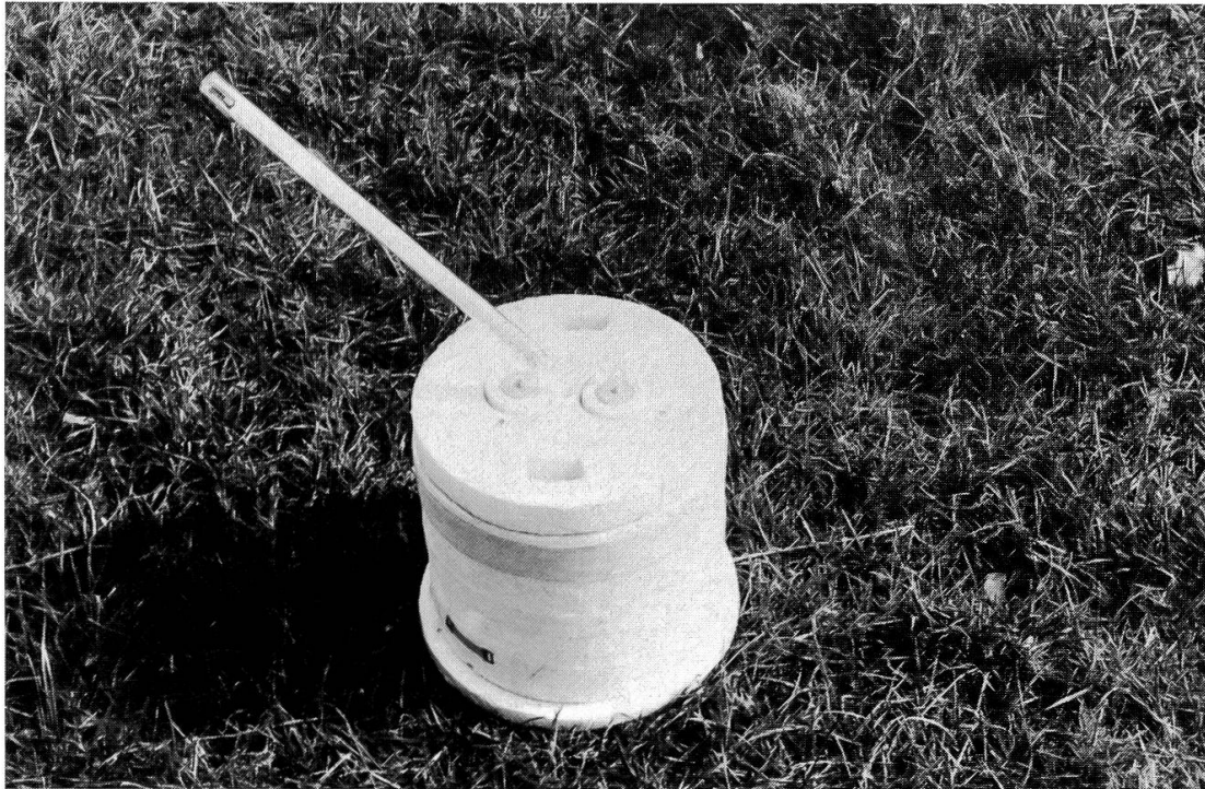
Abb. 22: Gefäss mit äusserem Deckel und Tauchrohr-Thermometer. Die viereckigen Öffnungen werden nach dem Einfüllen des Trockeneises jeweils wieder verschlossen.
