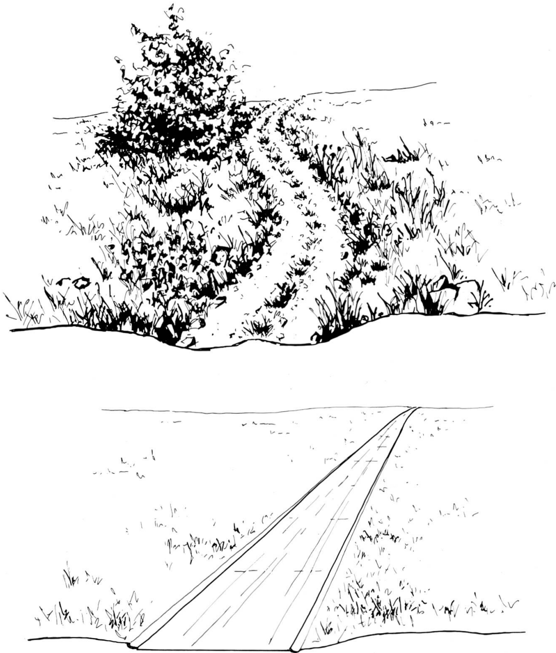
Abb.30: Gewässer vor und nach der Korrektur und die Veränderung vom Flurweg zur Güterstrasse. Das Ersetzen der Ufer und deren Vegetation durch Steine oder Zementplatten bedeutet Saum- und Flächenverluste für den Naturhaushalt. Die Veränderung des Flurweges besteht im Aufheben der Randstreifen und deren Vegetation sowie im Ersetzen des Weichbelages mit Trittgemeinschaften durch Schotterkoffer und Hartbelag
