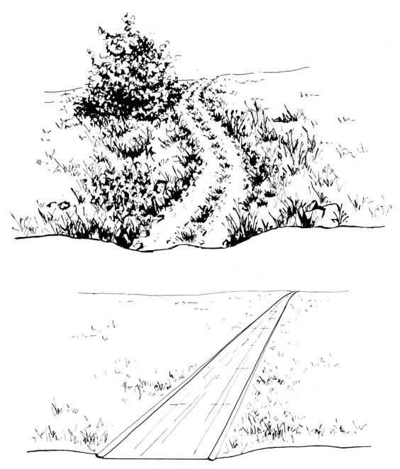
Abb. 30: Gewässer vor und nach der Korrektion und die Veränderung vom Flurweg zur Güterstrasse. Das Ersetzen der Ufer und deren Vegetation durch Steine oder Zementplatten bedeutet Saum- und Flächenverluste für den Naturhaushalt. Die Veränderung des Flurweges besteht im Aufheben der Randstreifen und deren Vegetation sowie im Ersetzen des Weichbelages mit Trittgesellschaften durch Schotterkoffer und Hartbelag
