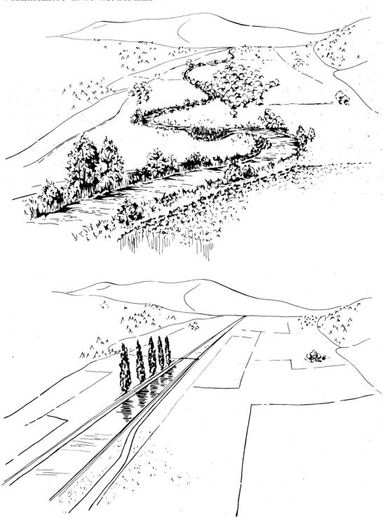
Abb. 34: Begradigung eines mäandrierenden Gewässers
