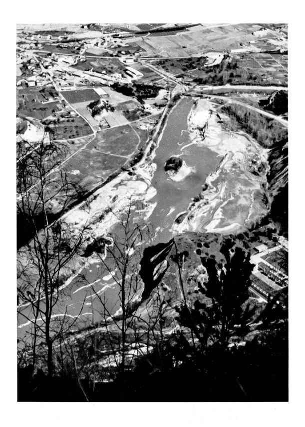
Abb. 24: Sand- und Kiesausbeutungen aus einem Fluss verändern Bett und Ufer und damit den Naturhaushalt
