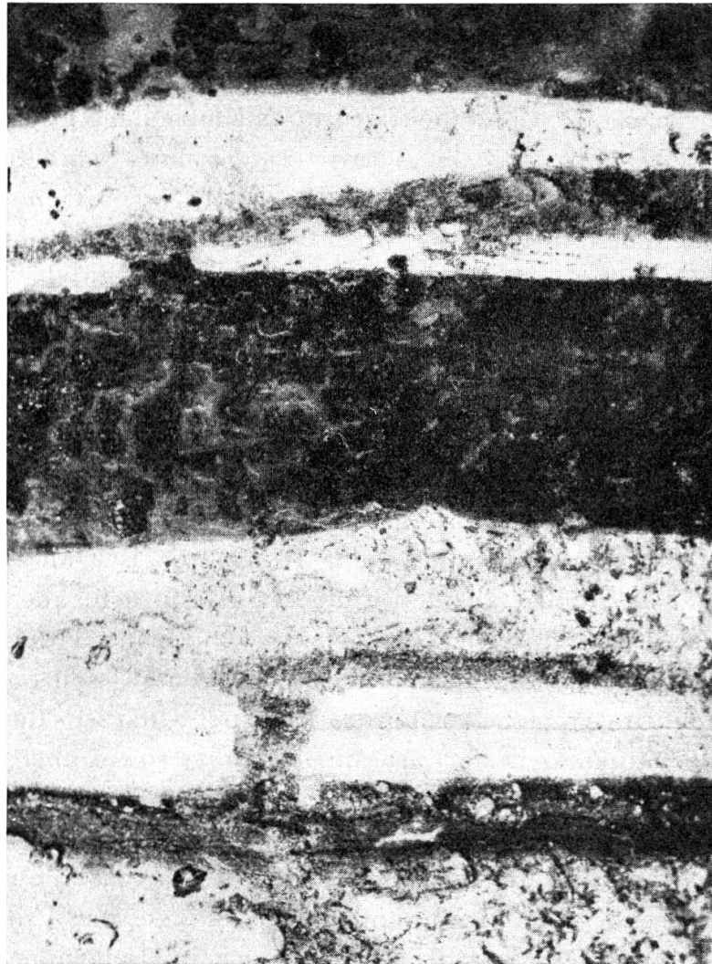
Abbildung 7. 1.5 : 1 (Handstück) Tiefe: 203.90 m Wechselagerung von rotem (dunkelgrau) und grünem (weiss) Ton. Unten ist der grüne Ton feldspat- und quarzreich.
