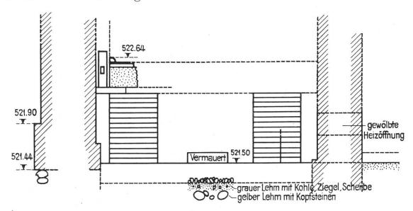
Fig. 6 Hypokaustquerschnitt
