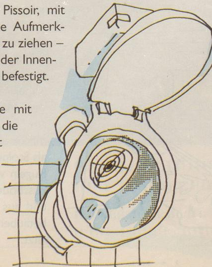
dafür bestimmt, in der Gänze innerhalb der Klosett- oder Pissoirschale untergebracht und dauerhaft befestigt zu sein, besteht aus flexilem Material, welches bevorzugt eine graphische Zwischenschicht, eine äussere wasserfeste Schicht und eine innere Klebeschicht, die nicht wasserlöslich ist, aufweist. Die Zielscheibe hat keine beweglichen Teile und ist ausreichend biegbar, um sich an eine Oberfläche, die mindestens in zwei Richtungen gekrümmmt ist, anpassen zu können.
