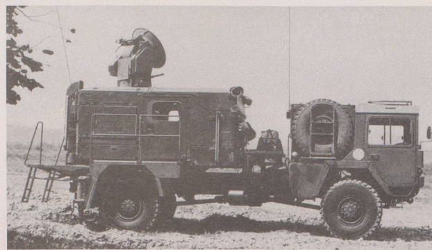
Eine der neusten Errungenschaften: Der TV-Wagen 89. 22 (!) Fernsehprogramme können mit der Parabolantenne empfangen und via Kabel in das Reg-Kp oder das Wachlokal übertragen werden.
