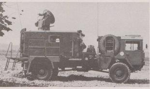
Eine der neusten Errungenschaften: Der TV-Wagen 89. 22 (!) Fernsehprogramme können mit der Parabolantenne empfangen und via Kabel in das Reg-Kp oder das Wachlokal übertragen werden.
