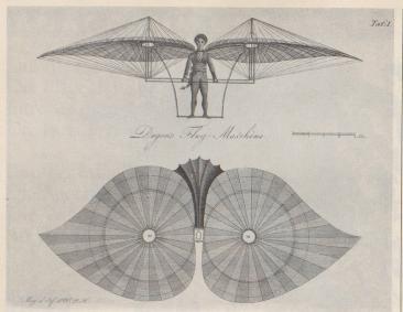
Zeitgenossen bezeichneten Jakob Degens Schlagflügelapparat mit seinen insgesamt 6000 Klappen aus gefirnistemPapier als «Meisterwerk der Feinmechanik».
